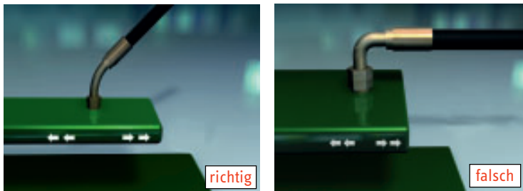
Abbildung 15: Verlegung bei Schwingungen
