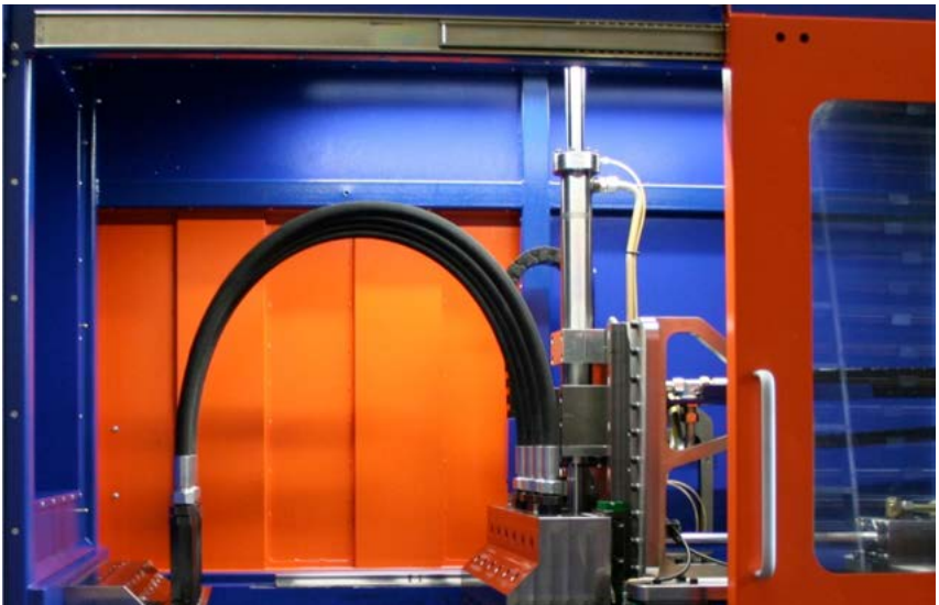
Abb. 3 Impuls-Prüfstand beim Schlauchleitungshersteller
