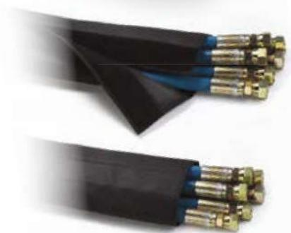
Schutzschlauch aus abrieb- und hitzebeständigem Fasergeflecht zum Schutz vor unkontrolliertem Ölaustritt, mit Klettverschluss zur nachträglichen Montage
