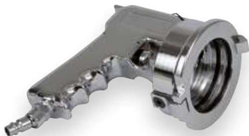
Kernstück des Systems ist die ergonomisch geformte Pistole aus hochfestem Aluminium. Die verchromte und robuste Ausführung garantiert eine lange Lebensdauer, auch in rauer Arbeitsumgebung. Der Leistungsbereich der Pistole umfasst Schläuche von DN 6 - DN 51 sowie Rohre mit einem Außendurchmesser von 6 mm bis 65 mm. Zum besseren Handling sind die Geräte mit einem drehbaren Druckluftanschluss versehen.
